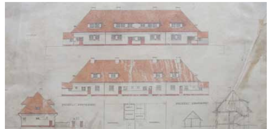
Alois Kubíček, návrh čtyřpodlažní hornické kolonie typu C-D-D-C, 1923. Typ uplatněn u kolonie v Horním Litvínově a Mstišově (reprodukce autor, NTM, AA, fond 137 – Alois Kubíček, sloha Domky pro hornickou kolonii).
