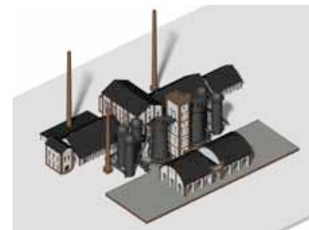
Axonometrie areálu Žofinské hutě mezi lety 1883 až 1889, stavba pomocné dmychadlovny a kotelny, přístavba kotelny č. 1, nové ohříváče větru typu Cowper (autor Radek Míšanec).
