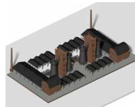
Axonometrie nerealizovaného návrhu na stavbu čtyř vysokých pecí skotského typu Žofinské huti, 1871 (autor Radek Míšanec).
